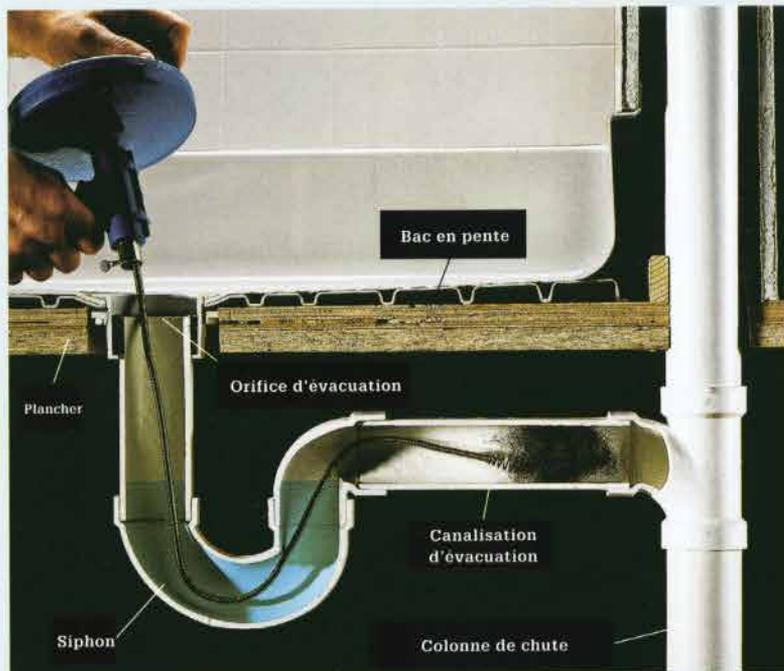
Le dispositif d'évacuation d'une douche est composé d'un bac en pente, d'un orifice d'évacuation, d'un siphon ainsi que d'une canalisation d'évacuation raccordée à une conduite d'évacuation secondaire ou à la colonne de chute.
