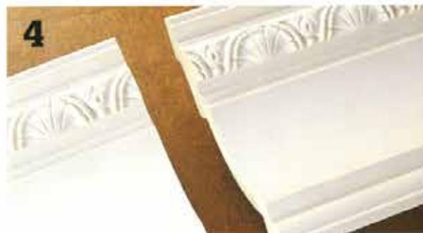
**4** **Vérifiez les extrémités non coupées de chaque morceau** de moulure avant d'installer celui-ci. Chaque morceau doit s'appuyer d'équerre contre le morceau adjacent pour former un joint serré. Coupez toutes les extrémités d'équerre à l'aide d'une scie à onglets à commande mécanique ou d'une boîte à onglets et d'une scie manuelle.
